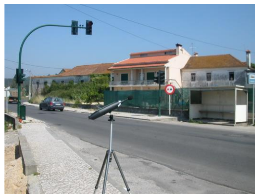
Figura 7 – Exemplo de monitorização do nível de pressão sonora junto a uma via rodoviária
