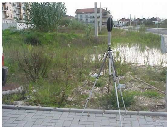
Figura 20 – Kit de exteriores utilizado para monitorização permanente
