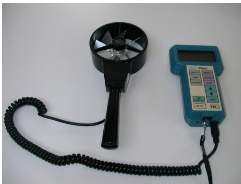
Figura 21 – Sensor de velocidade do ar tipo turbina.
